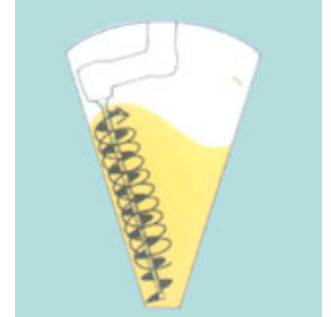
C：物料从螺杆甩下，被带到槽后对面，如此循环，完成混合
