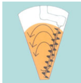
A：混合螺杆通过自转用来提升物料
